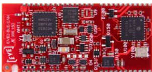
EVE2 BLE CAN module – actual size
